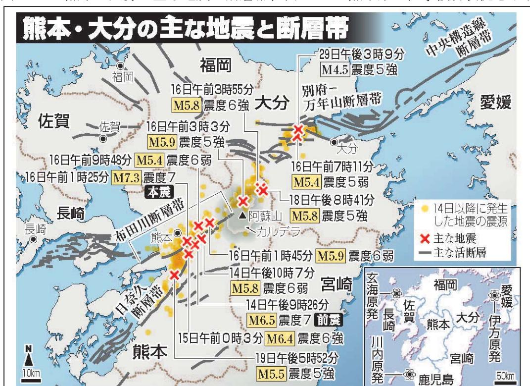
図2-2 熊本・大分の主な地震と断層帯 (提供:共同通信社)
